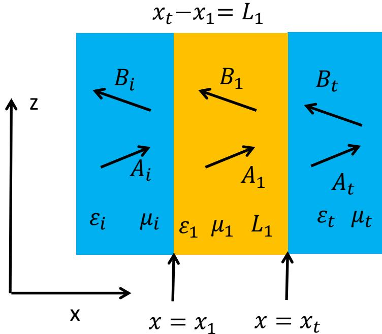
$$\begin{bmatrix} A_t \\ B_t \end{bmatrix} = \begin{bmatrix} (T_{TE})_{11} & (T_{TE})_{12} \\ (T_{TE})_{21} & (T_{TE})_{22} \end{bmatrix} \begin{bmatrix} A_i \\ B_i \end{bmatrix}$$
